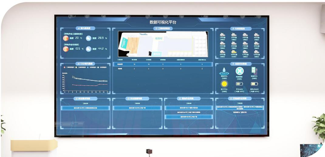
采用三屏显示，需要支持对大屏幕的管控与开关机操作，三个屏幕同时与讲台中控连接进行控制，支持一键开关操作，支持内容分屏显示，主屏幕显示PPT演讲内容，辅助显示可显示老师板书内容，也可以三屏显示同样内容。
